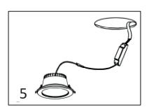
LED-Treiber an einer geeigneten Stelle an der Decke anbringen.
