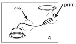
Primärseitig: die Netzspannung (220-240 V) am LED-Treiber anschließen. Sekundärseitig: vormontierte Anschlußkabeln von Treiber und Leuchte mittels Stecker und Buchse verbinden.
