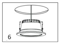
Beide Federn aufklappen; die Leuchte in den Deckenausschnitt einführen & vorsichtig einsetzen; die Federn runterklappen lassen;
