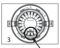
Mit dem DIP-Schalter an der Rückseite die gewünschte Farbtemperatur auswählen.
