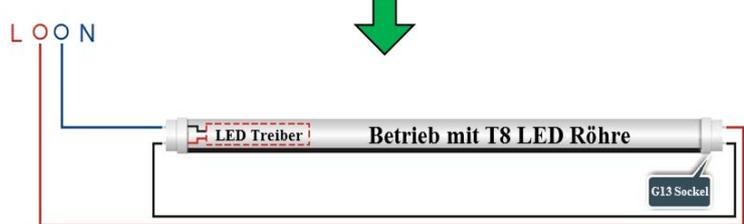
**KVG/VVG-Leuchte:** Der Starter muss immer getauscht werden; Magnetische Vorschaltgeräte können belassen werden und dienen als Überspannungsschutz. Es bleibt jedoch eine geringe Verlustleistung bestehen. Eine Umbaukennzeichnung auf der LED bzw. Leuchte muss angebracht werden!
